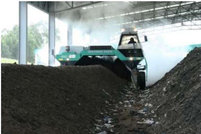
**Ilustración 43 Sistema de compostaje en pila volteada.**
