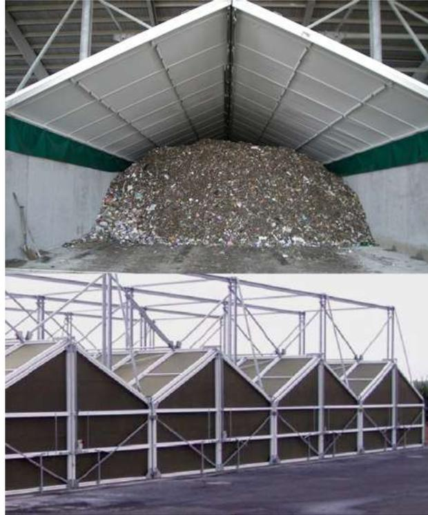
**Ilustración 44 Sistema de compostaje en túnel.
